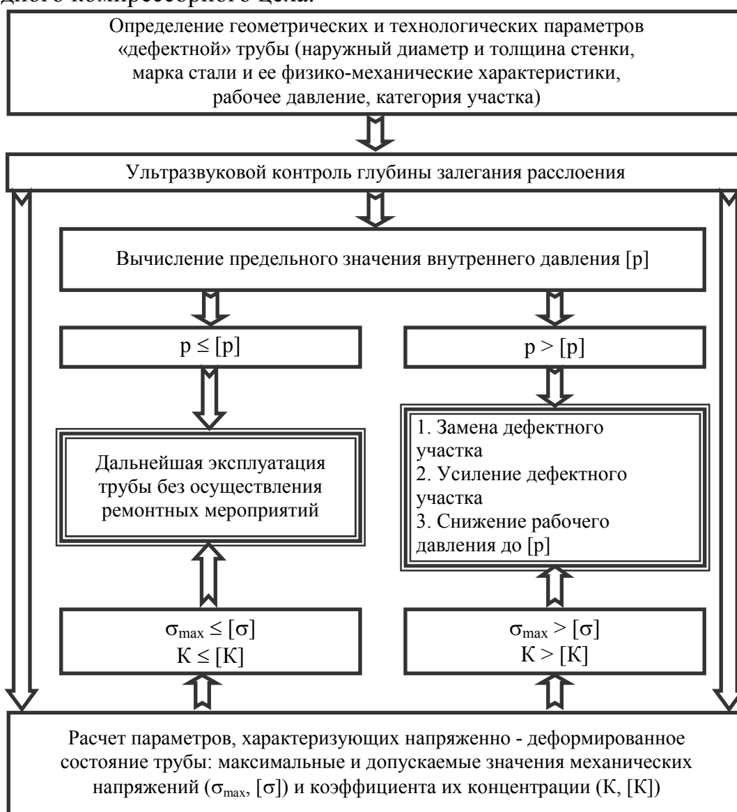
Рис. 9. Алгоритм оценки работоспособности трубы с внутренним расслоением стенки
