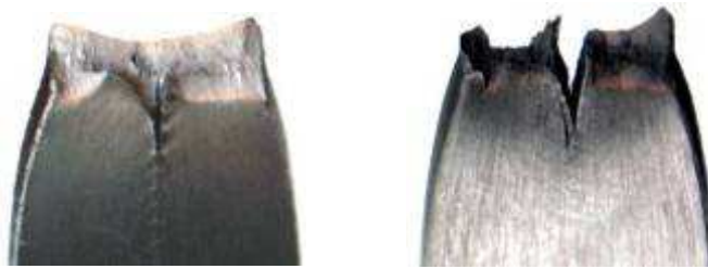
Рис. 7. Характер линий разрушения образцов с внутренними несплошностями
