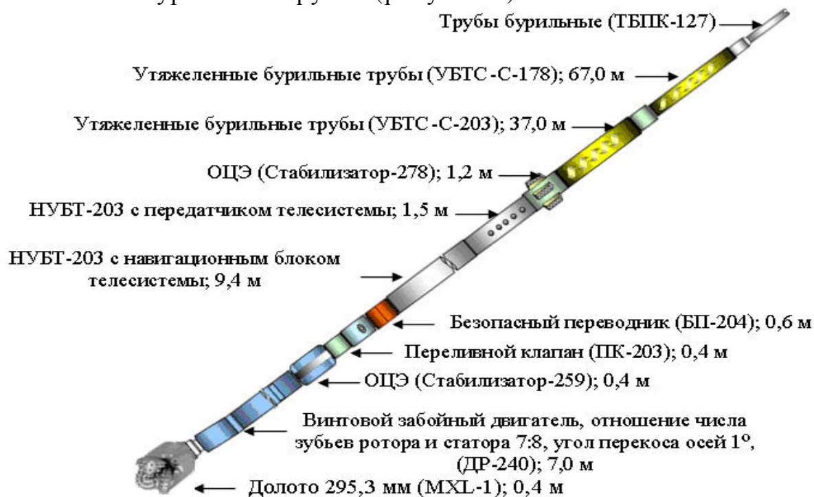
Рисунок 1 – Компоновка низа бурильной колонны
