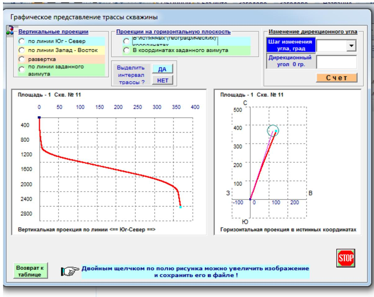
Графическое отображение вертикальной и горизонтальной проекции скважины и ее заданного направления
