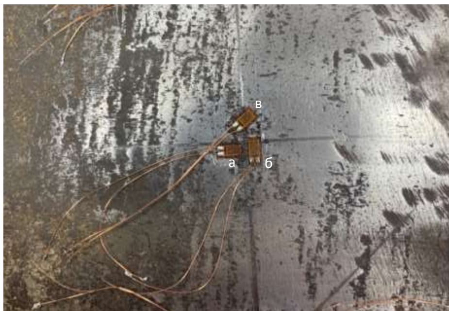
а. тензодатчик, установленный в продольном направлении; б. тензодатчик, установленный в кольцевом направлении; в. тензодатчик, установленный под углом 45^\circ к оси трубы.
