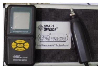
Рисунок 2.4 – Портативный виброметр Smart Sensor AR63B
