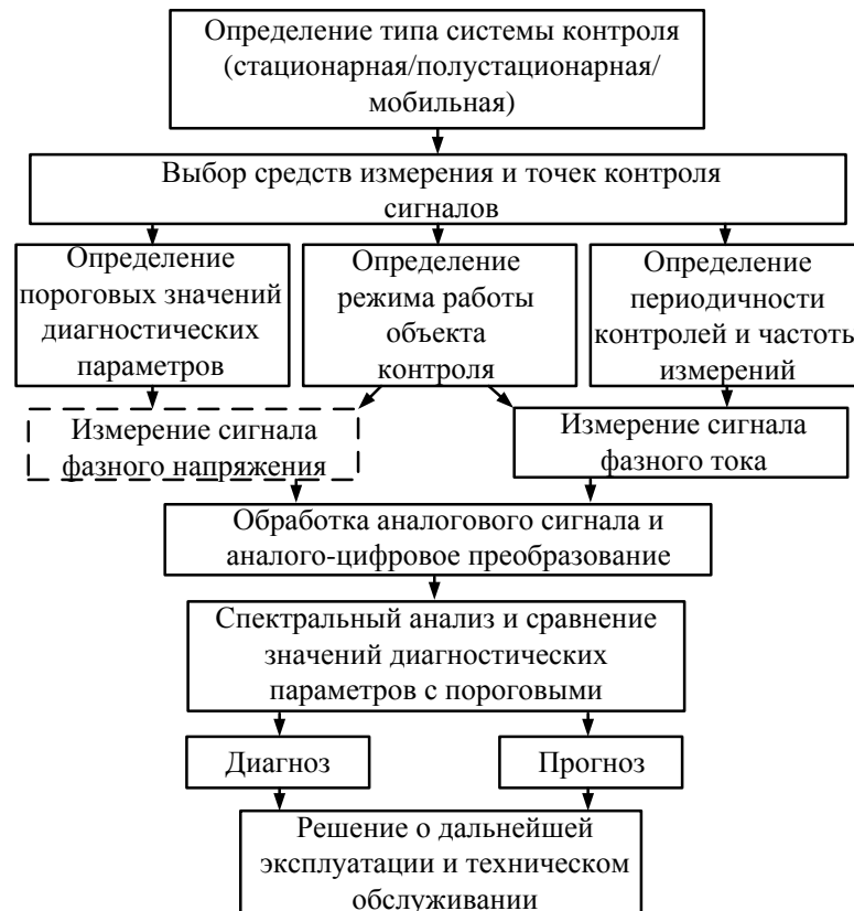
Рисунок 1.6 – Порядок оценки состояния узлов ЦНА анализом спектров тока двигателя
